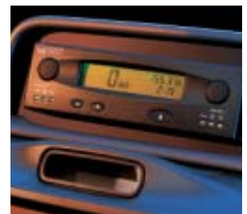
Cronotachigrafo digitale (disponibile su Combi come optional a costo aggiuntivo, standard su Minibus).
